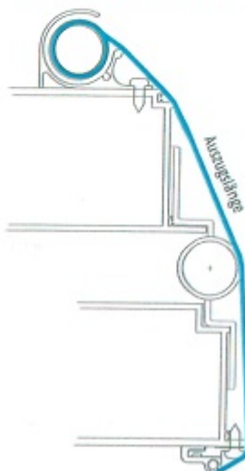
Türe offen, Rollo ausgezogen
