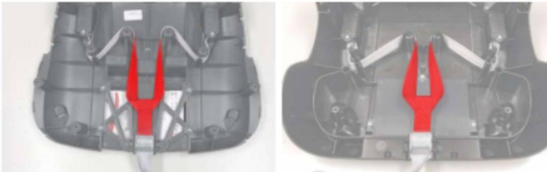
Diese Ausgestaltung ermöglicht eine Kraftaufspaltung von dem Einzelstrang (mittlerer Schenkel) seitlich nach außen auf die beiden gegenüberliegenden Gurtstränge, die jeweils ein Sicherungsende des Haltegurts umfassen. 210
